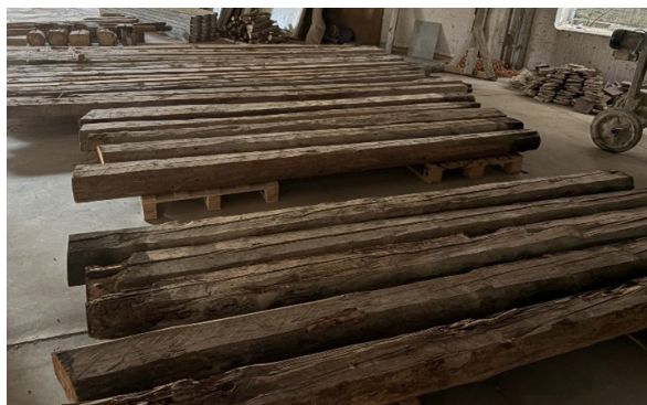
Esempi di recupero di travi in legno di sottotetti, e di tegole settecentesche del Complesso Mauriziano
